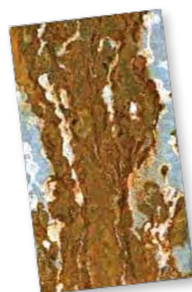
zincato 20 µm dopo 6 settimane = 1.000 ore
