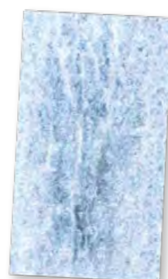
Magnelis® 20 µm dopo 34 settimane = 5.700 ore
